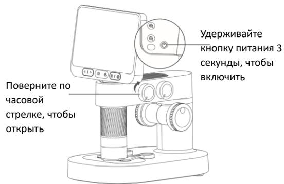
3. Отрегулируйте ручку подъема микроскопа, чтобы тубус находился на подходящей высоте, удобной для размещения объекта наблюдения.
